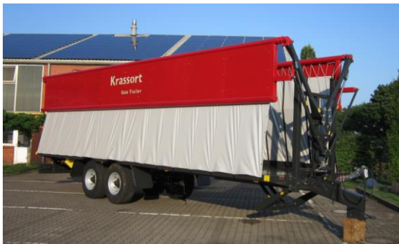
Blechbeplankung / Plane beidseitig
